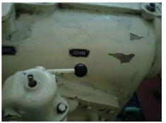
**5.2.4** Se lleva el volante hasta la posición de cierre de Alabes Guías y la palanca de MANIOBRA A MANO se lleva a posición de INCLUYE, ajustando el volante en posición de cierre.
