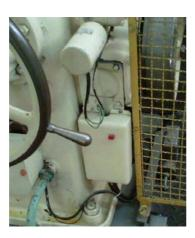
**5.1.2** Tensar la correa de accionamiento del regulador, liberando totalmente la fijación del tensor y dejando que este caiga por su propio peso, luego ajustar para que quede en esa posición.
